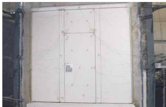
Um die Feuerwiderstandsklasse zu ermitteln, wurde in einem Prüflabor eine Wandseite der Variflex EI 30 mit integrierter Durchgangstür über eine halbe Stunde lang direktem Feuer ausgesetzt.
